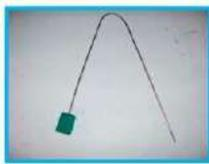
K 型 NiCr/Ni 合金化学热电偶 (0° C 至 1100° C) 长度 500 mm 直径 3 mm 热电效应阴性插座
