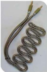
5 - 用于焊接预热的加热元件 (热电偶) 和热绝缘的安装
