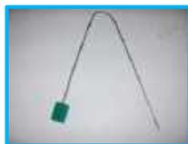
Thermocouple chemisé Type K
