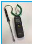
Sonde thermocouple type K à contact
