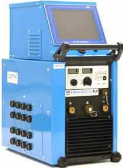
La nouvelle machine TT13CC permet d'alimenter en courant continu 8 résistances de 1,6KW avec 6 zones de régulation. Développée sur la base d'un poste EXAGON 400 de Gys, la TT13CC est équipée du même interface que sur nos autres machines qui permet de piloter facilement la chauffe de vos pièces. Vous pouvez encore utiliser la fonction soudage de cette machine quand la chauffe est coupée.
