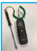
Sonde thermocouple type N à contact
