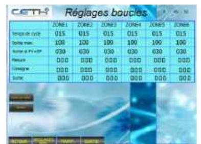
Programmeur, réglage des boucles et paramètres PID
