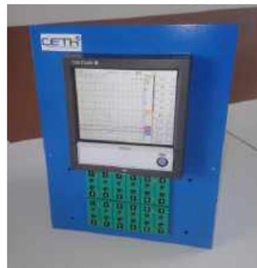
Equippé d'embases pyrométriques type K ou N, d'une prise d'alimentation 220V, de poignées et d'un capot de protection avec plexiglas\*.
